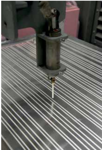
Spuitkop die 42 banen naast elkaar over een paneel van 1 meter bij 1 meter 60 aanlegt.
